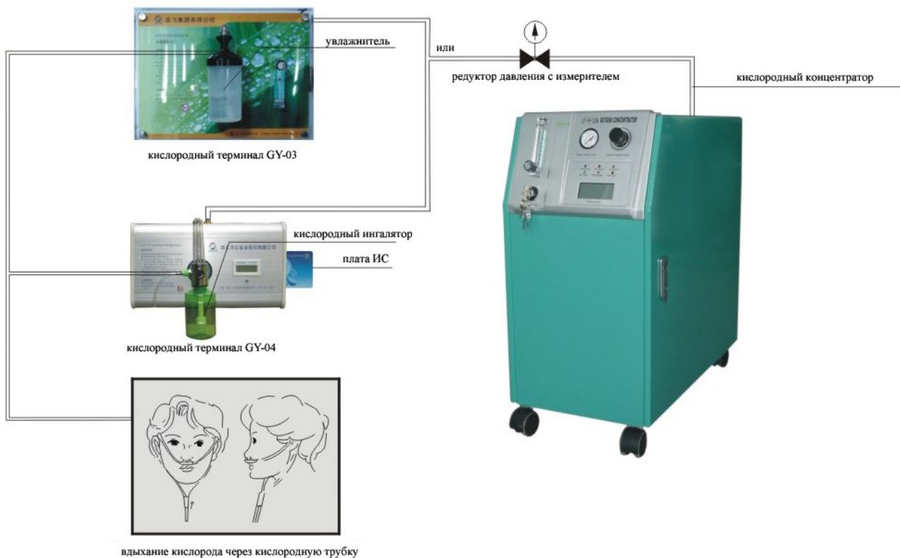
Рис. 6. Подключение кислородного концентратора к кислородным терминалам (сверху вниз).
